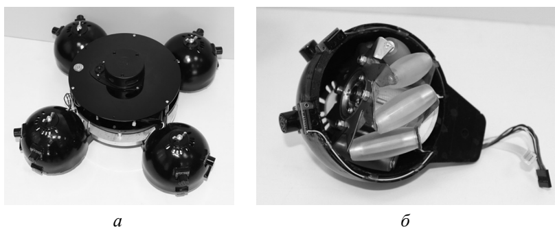
Рис. 1. Высокоманевренный мобильный робот: а – конструкция в сборе; б – отдельный колесный модуль
