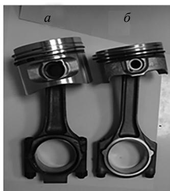
**Рис. 4. Модернизация сборочной единицы «поршень в сборе»:**
