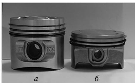
**Рис. 3. Модернизации поршня двигателя ВАЗ 21124:**
