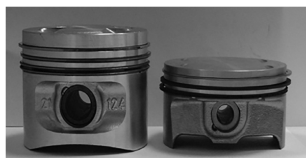
Рис. 2. Модернизации поршня двигателя ВАЗ 21124: а – поршень двигателя ВАЗ 21124 (до модернизации); б – поршень двигателя ВАЗ 21126 (после модернизации поршня двигателя ВАЗ 21124)
