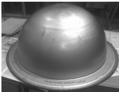
Рис. 1. Общий вид штамповки «полусфера» [2], изготовленной методом газовой формовки в режиме сверхпластичности материала из титанового сплава ВТ-23
