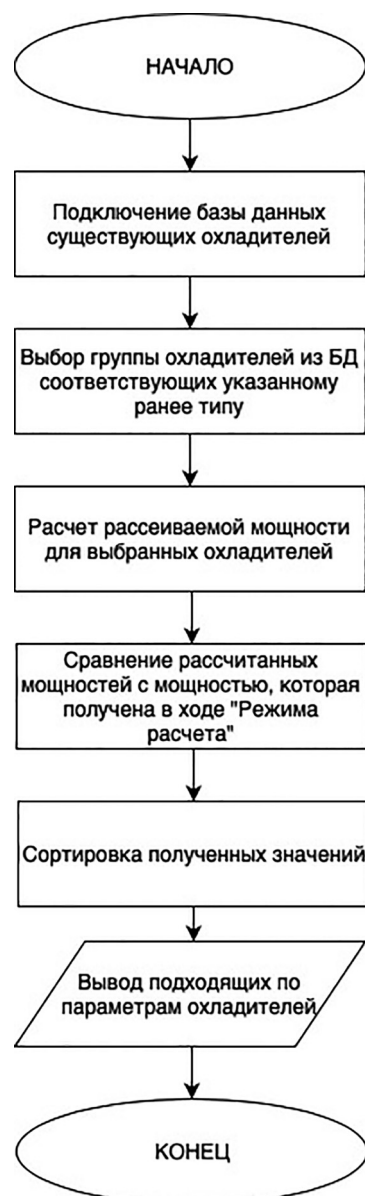
Рис. 12. Блок-схема режима «Выбор аналога»
