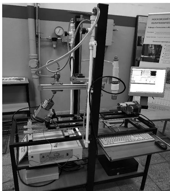
Рис. 1. Схема и фото оборудования с механизмом крепления режущего инструмента для его упрочнения установкой «УИВ»:
