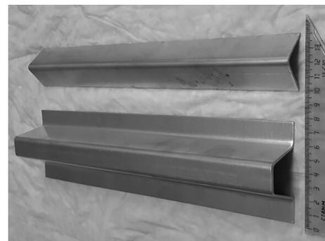
Рис. 6. Типовые тонколистовые профили из сплава В-1341Т1
