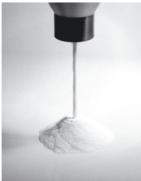
Рис. 6. Истечение порошковой пробы 1 из стальной воронки
