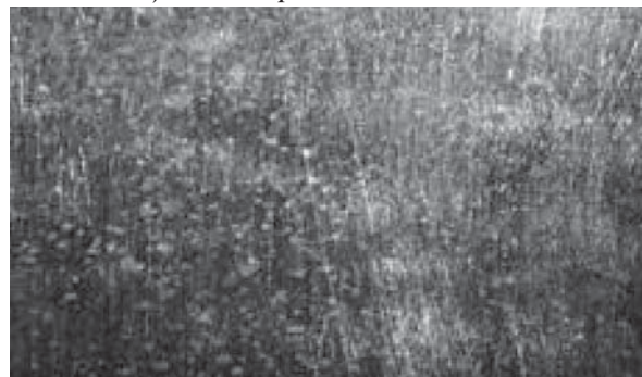
Рис. 6. Микроструктура обратной стороны стальной пластины, легированной медью и вольфрамом с помощью электрохимического метода
