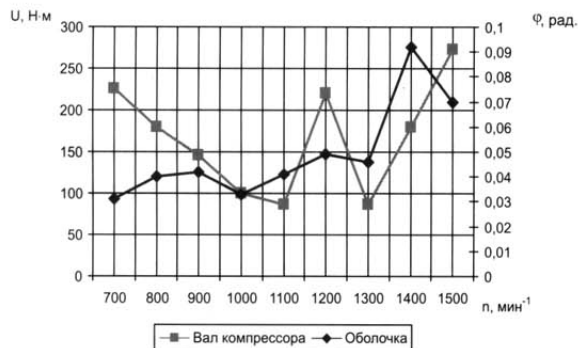
Рис. 9. Изменение динамического крутящего момента на рабочем диапазоне частоты вращения двигателя
