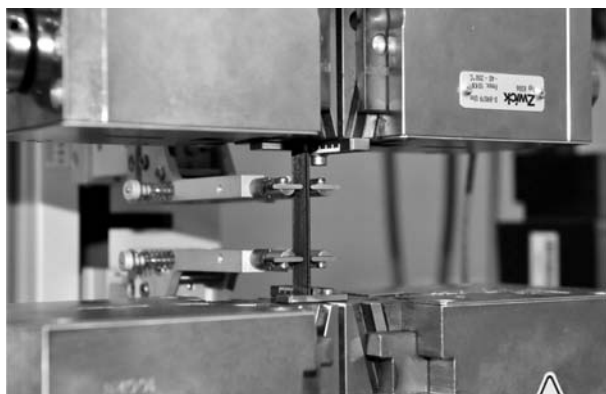
Рис. 4. Разрывная машина с образцом, установленным в клиновидных захватах
