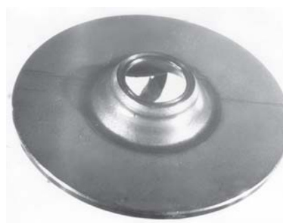
Рис. 6. Внешний вид пластины с коническим выступом после деформирования
