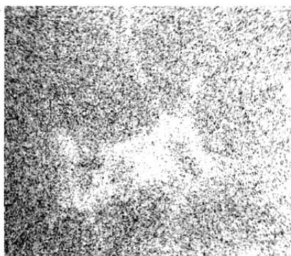
Рис. 4. Растровые изображения феррита в металле шва типа 04Х19Н11МЗ в рентгеновском излучении хрома (слева) и никеля (справа) \times 4000
