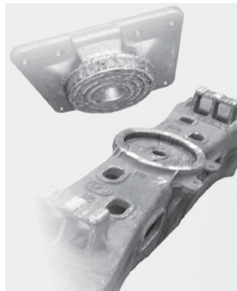
Рис. 5. Пятник и подпятниковое место вагонной тележки с плазменной закалкой
