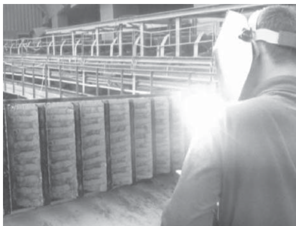
Рис. 2. Закалка зубчатого венца на шихтовом дворе агломерационного цеха
