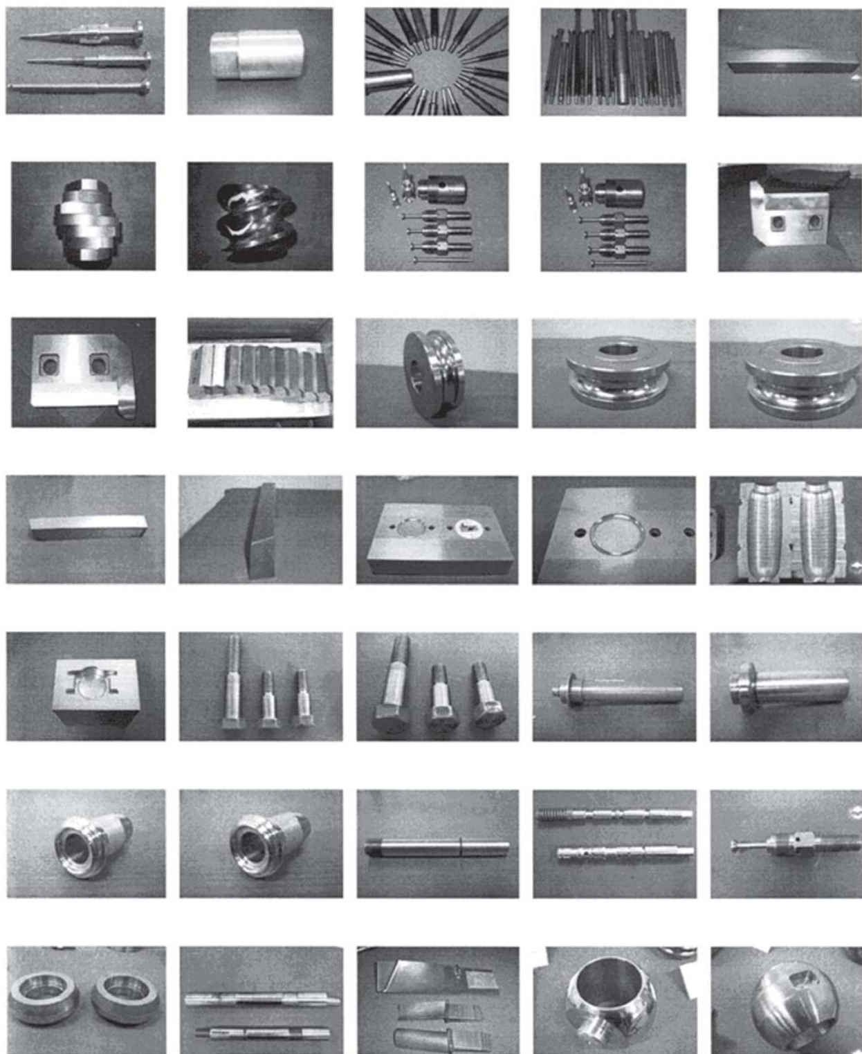
Рис. 17. Ассортимент деталей, обработанных УЗО
