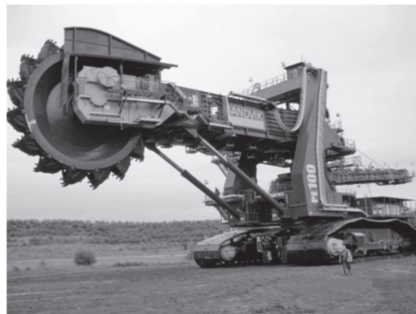
Рис. 1. Роторный экскаватор в сложенном положении стрелы
