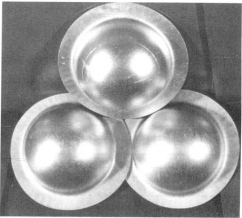
Рис. 3. Днища баллонов с технологическим припуском после холодной штамповки из листа сплава В1341
