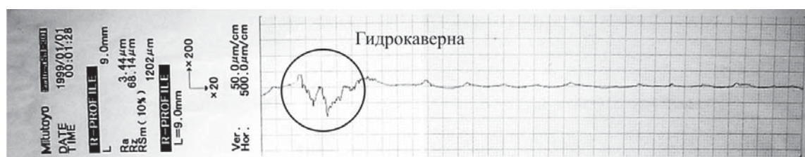
Рис. 2. Профилограмма поверхности гидрокаверны неупрочненной шестерни (масштаб по вертикальной оси – 50 нм/см, по горизонтальной оси – 500 нм/см, протяженность замера – 9 мм)
