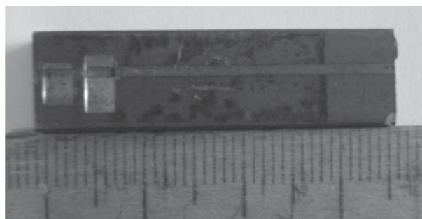
Рис. 5. Образец после износостойких испытаний, подвергнутый гидроэрозионному воздействию
