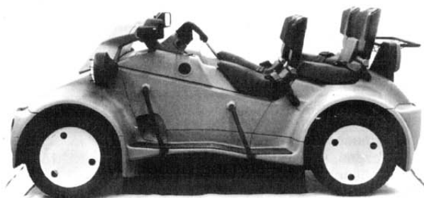
Рис. 3. Четырехместный квадрицикл с мотоциклетной посадкой
