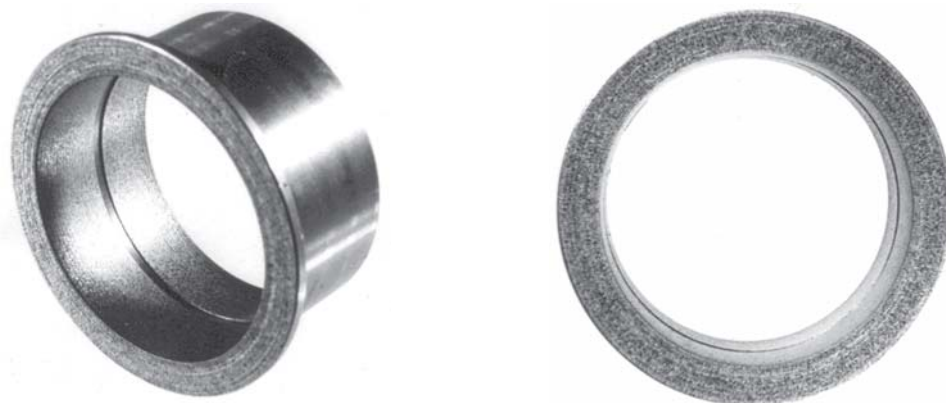
Рис. 8. Втулка из стали 30XГСН2А узла механизации крыла самолета МиГ-АТ, на торцевую и внутреннюю поверхности которой нанесено покрытие бронзы БрАЖМц10-3-1,5
