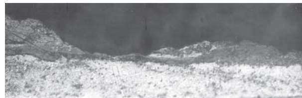
Рис. 3. Микроструктура слоя бронзы ВБр5М на стали 30ХГСН2А при электроискровом легировании с величиной продольной подачи детали 1,6 мм/об (x500)
