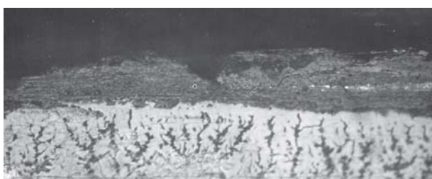
Рис. 5. Структура поверхностного слоя подложки стали 30ХГСН2А с сеткой микротрещин при ЭИЛ бронзой ВБр5М (x500)
