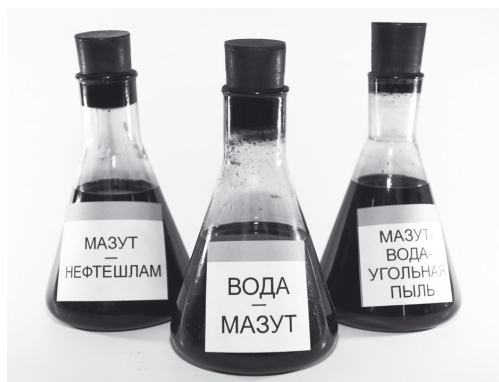
Рис. 8. Тонкодисперсные (1–3 мкм) и стабильные водотопливные эмульсии (стабильность – месяцы и годы)
