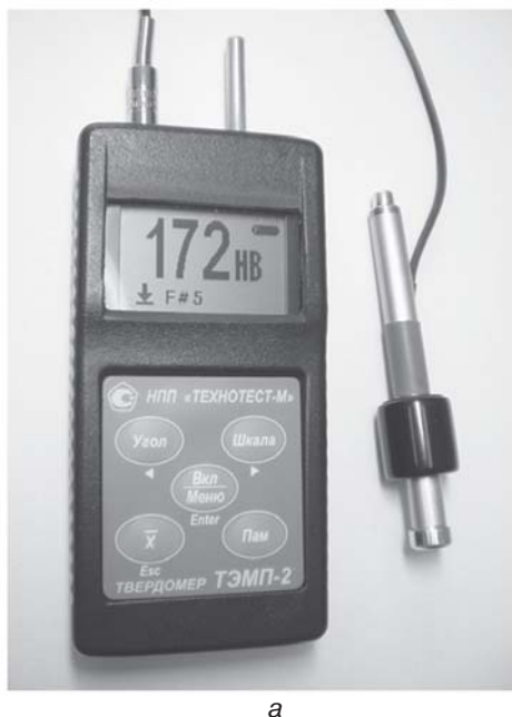
Рис. 4. Электронные малогабаритные переносные твердометры ТЭМП 2у (а) и ТЭМП 4к (б)
