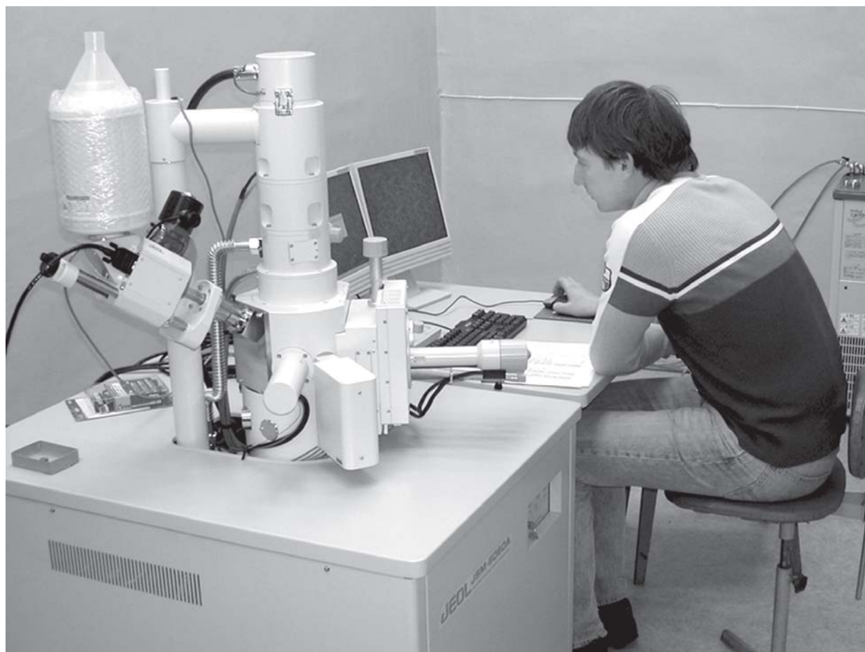
Рис. 1. Сканирующий электронный микроскоп JEOL 6060 с энергодисперсионной приставкой JED 2300
