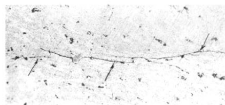
Рис. 11. Микротрещина в зоне точки 3 (x200)
