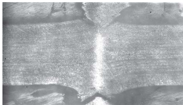
Рис. 1. Макроструктура сварного соединения ленточной пилы из стали CR400
