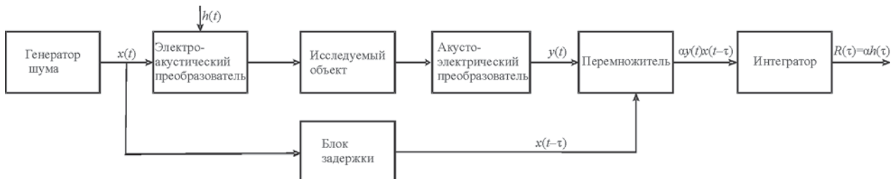
Рис. 2. Структурная схема корреляционного измерителя импульсной характеристики:
