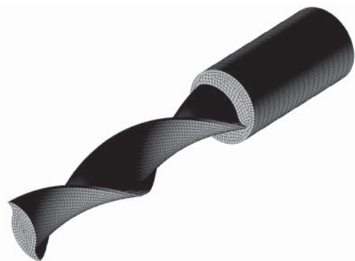
Рис. 1. Конечно-элементная модель (КЭ-модель) двузубой концевой фрезы
