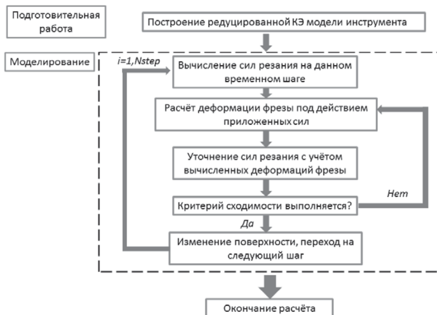
Рис. 2. Алгоритм работы программы расчета динамики фрезерования
