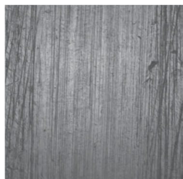
Рис. 7 Макроструктура Fe-Cu сплава легированного из расплава Pb-10%Sn-15%Zn
