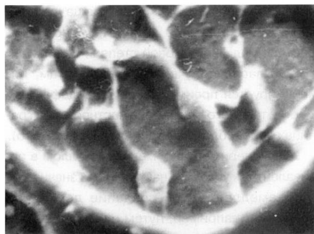
Рис. 4. Разделение дендритов железа
