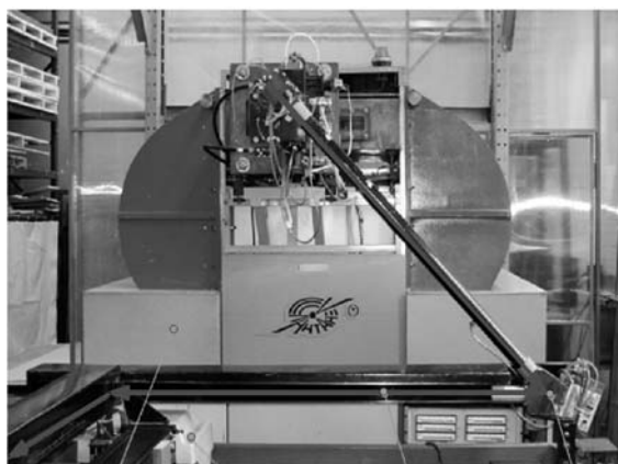
Рис. 1. Лазерный технологический комплекс с несамостоятельным тлеющим разрядом «Лантан-3»
