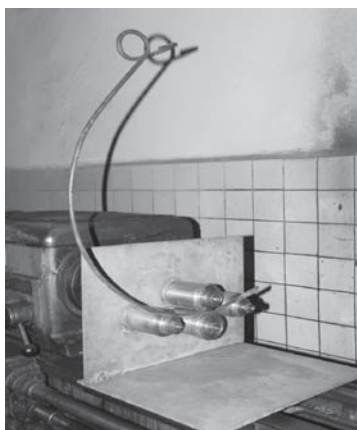
Рис. 3. Устройство для восстановления пружинных зубьев ЭМО
