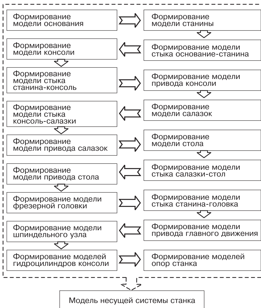
Рис. 2. Последовательность инициализации макросов при построении модели несущей системы
