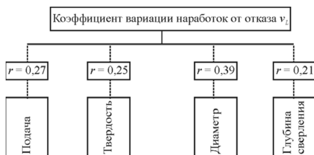
Рис. 5. Связь коэффициентов вариации v_L наработок до отказа с условиями обработки
