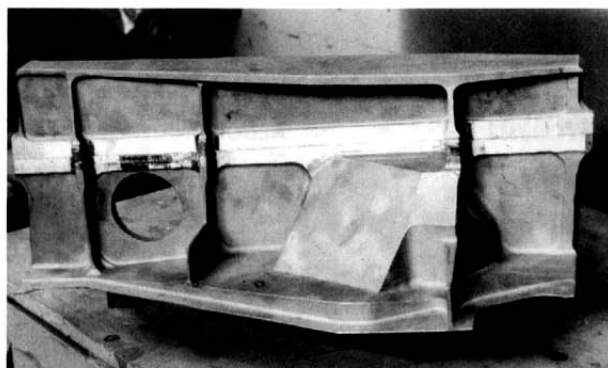
Рис. 10. Хвостовая часть фюзеляжа. Сборка детали под электронно-лучевую сварку
