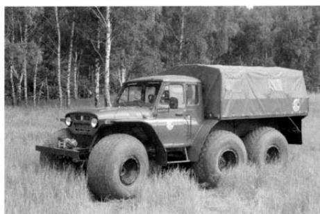
Рис. 2. Внедорожник ТРЕКОЛ-39293 на шинах сверхнизкого давления. Производитель – ООО «ТРЕКОЛ»
