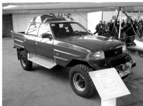
Рис. 1. Полноприводный автомобиль сверхвысокой проходимости «Тачанка». Производитель – ГКЦ РФ ФГУП «НАМИ»
