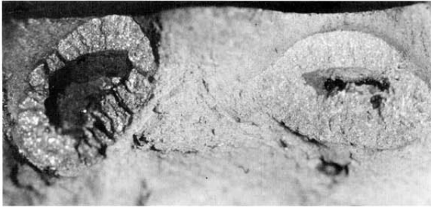
Рис. 7. Внешний вид участков несплавления в сварном шве (20-кратное увеличение)
