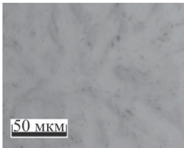
Рис. 1. Микроструктура сплава Al-Zn
