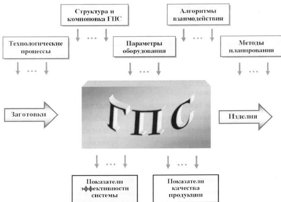
Рис. 2. Схема взаимной увязки решений на разных этапах создания и эксплуатации ГПС
