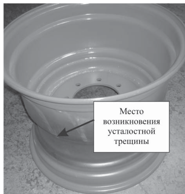
Рис. 1. Место возникновения усталостной трещины в колесе
