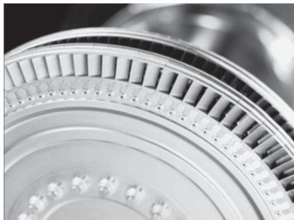
Рис. 2. Диск с лопатками и лабиринтным уплотнением турбокомпрессора LOX двигателя «Вулкан 2» производства Fiat–Volvo
