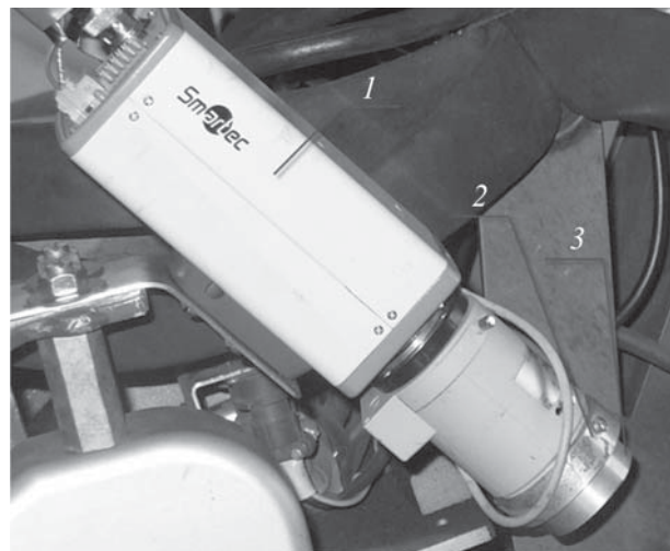
Рис. 10. Камера с насадкой: 1 – камера; 2 – насадка; 3 – фильтр
