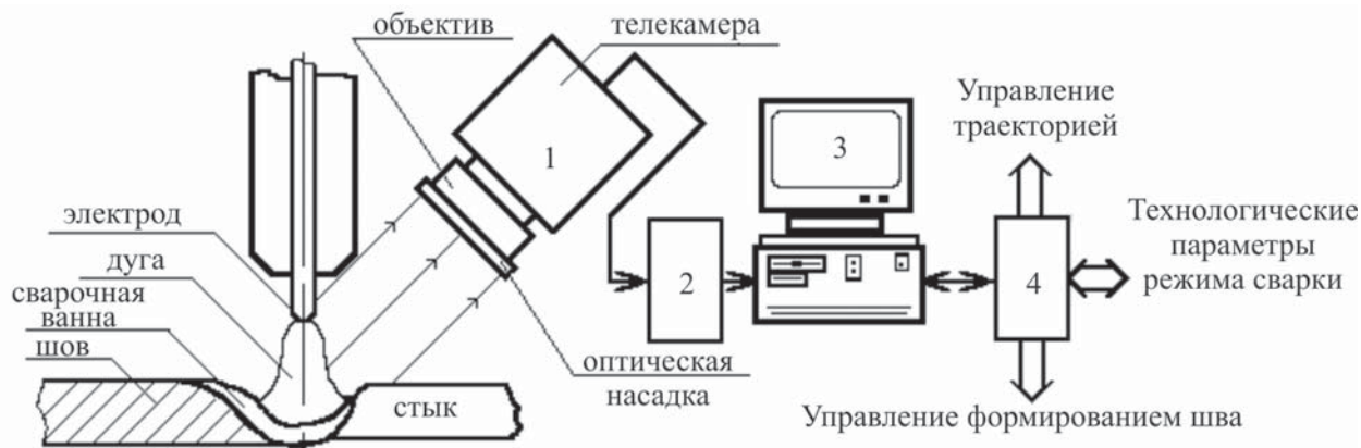
Рис. 1. Функциональная схема телевизионного модуля слежения за стыком:
