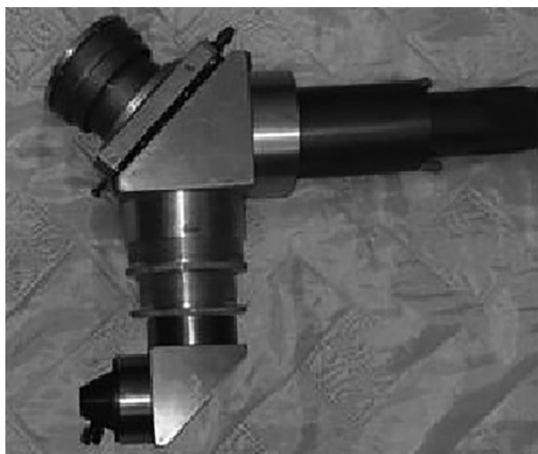
Рис. 6. Сканирующий блок LT-9 для обработки внутренних поверхностей
