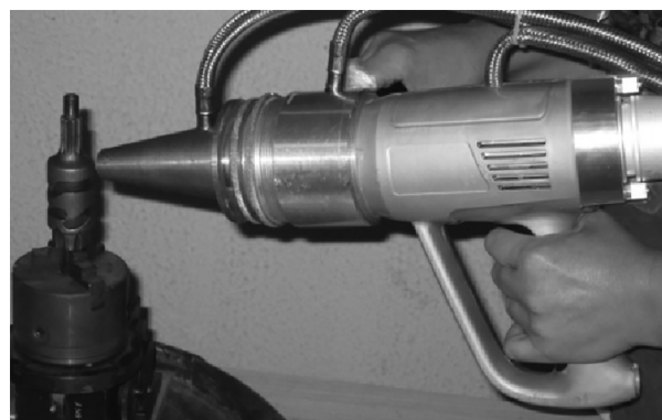
Рис. 7. Ручной блок для лазерной обработки
