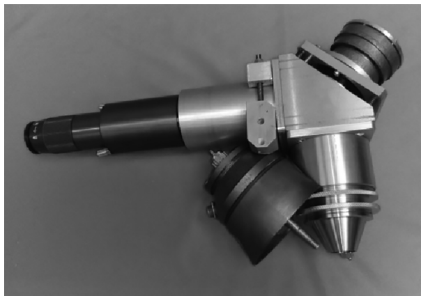
Рис. 4. Сканирующий блок LT-8 волоконного лазера
