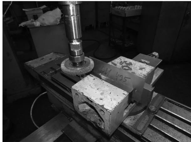
Рис. 5. Абразивно-полимерная щетка и обрабатываемая пластина
