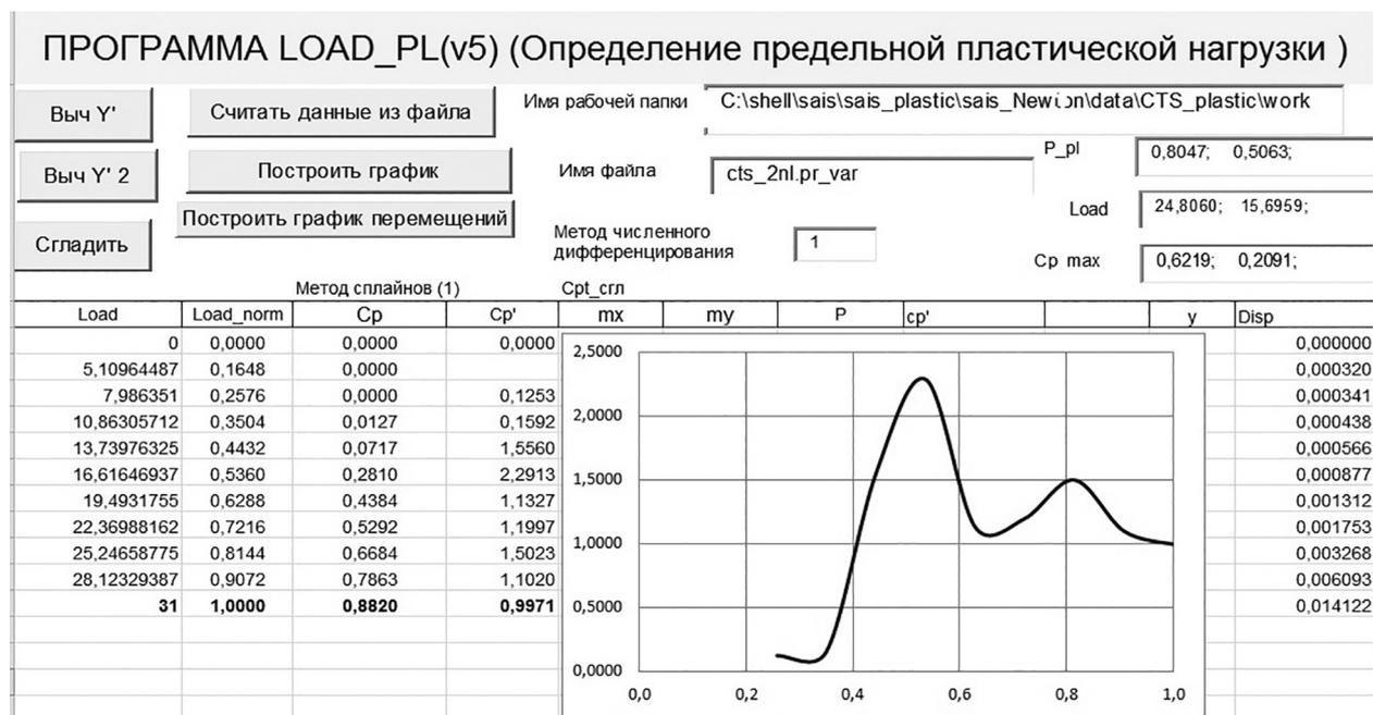
Рис. 4. Окно модуля Load\_PL при определении  $M_{np}$
