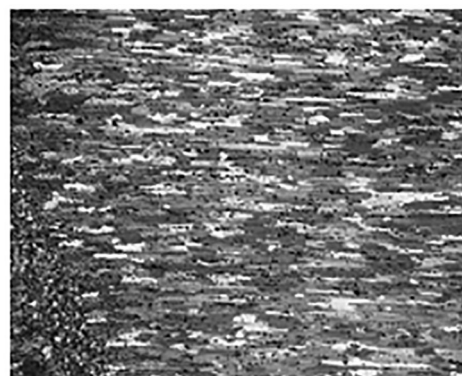
Рис. 6. Макроструктура сварного соединения сплава 1565чМ ( а , ×3), микроstructures металла шва ( б ) и зоны термического влияния ( в , ×200)
