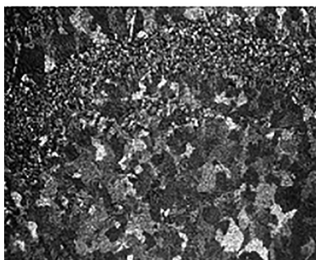
Рис. 6. Макроструктура сварного соединения сплава 1565чМ ( а , ×3), микроstructures металла шва ( б ) и зоны термического влияния ( в , ×200)
