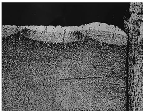
**Рис. 5. Микроструктура ЗЛВ при степени расфокусировки  $\alpha = 18^\circ$  ( $\times 100$ )**
