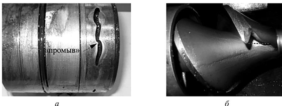
Рис. 1. Эрозионный износ в УЭЦН:
