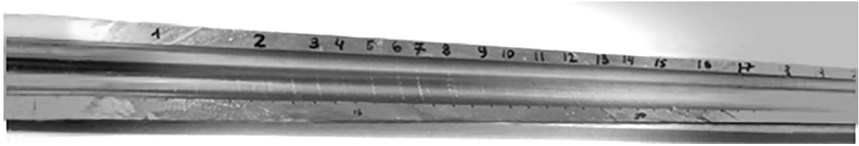
Рис. 2. Внешний вид внутренней поверхности рабочего конуса из сплава Zr-1Nb при прокатке на стане типа КРВ
